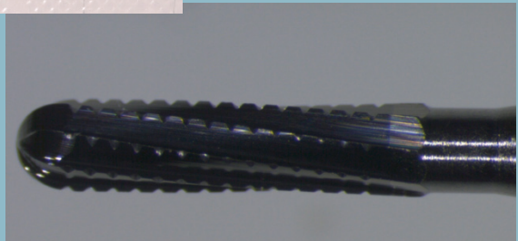
Εικ. 15. Η ίδια εγγλυφίδα κοπής μετάλλου, σε εικόνα από μικροσκόπιο προσπίπτοντος φωτισμού.
